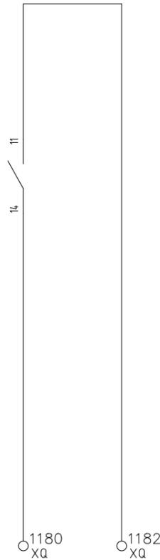
OPZIONE: PRESSOSTATO O TRASMETTITORE
